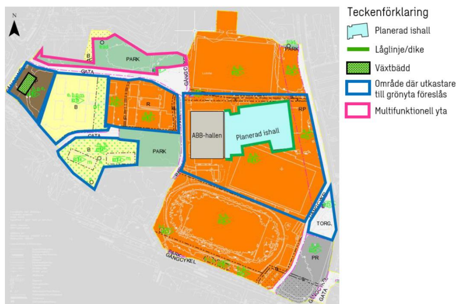
Förslag på systemlösning för dagvattenhantering, bilaga 7 Dagvattenutredning
